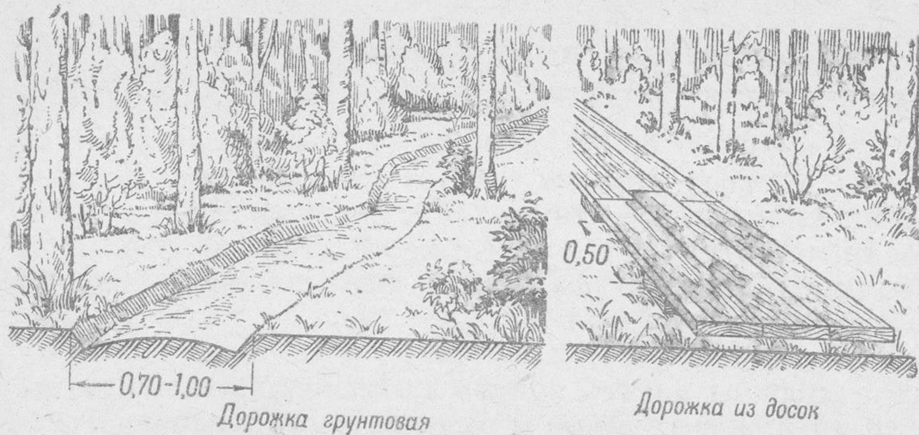
Рис. 2. Дорожки для пешеходов (размеры на рис. 2 и на всех остальных рисунках даны в метрах).
