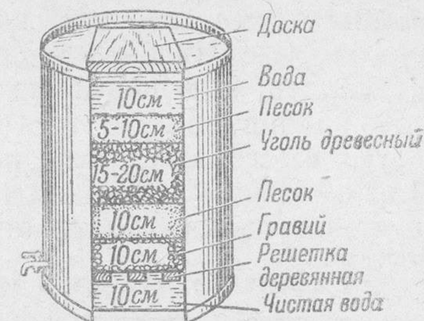
Рис. 28. Полевые фильтры из подручных материалов.
