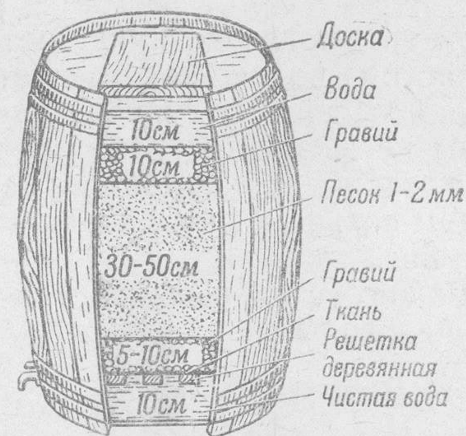
Рис. 28. Полевые фильтры из подручных материалов.
